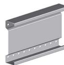
La viga secundaria es un perfil sigma, diseñado para asegurar que sea apenas sensible a la torsión bajo carga. Se dispone de una gama completa de perfiles sigma de acero de microaleación de alta calidad. El tipo de cubierta o rejilla de madera, su tamaño y la capacidad de carga determinan el espacio entre las vigas y el tipo de vigas secundarias.
